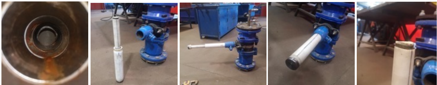
Figure 3: Fabricación de sistema cupones en taller de STLIMA, Galapagar (Madrid)
